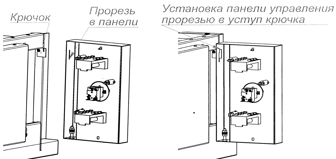
Рис. 8 Схема установки панели управления при ТО
